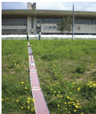
Рис. 3 Внешний вид георадара TP-ГЕО-00-12 производства ООО «Геологоразведка» (антенны по 7.07 м, по пять секций каждая). Длина радара – 16 м
